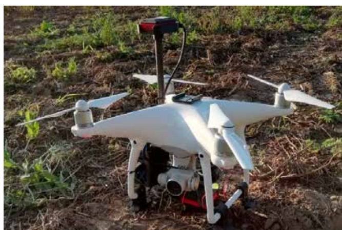
1. kép Felvételezést végző drón multispektrális kamerával
